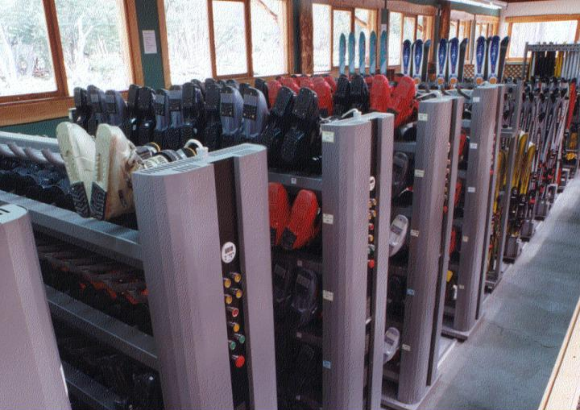
Sistema de desinfección, desodorización y calefacción.
